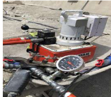
Pruebas de Carga de recibimiento y tesado de barras cota 3685.00
