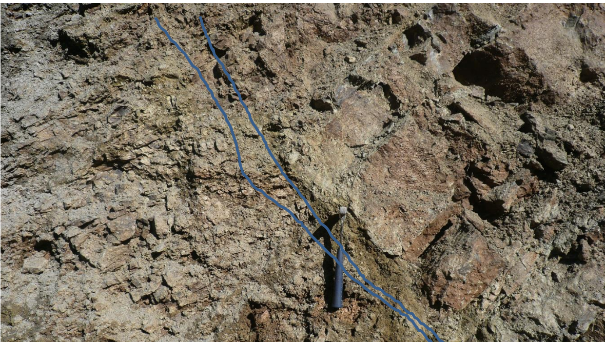
FOTO N° 4 Afloramiento de limolitas y siltitas con fracturamiento moderado talud comprendido entre cotas 3695 y 3705 (sector Norte).
