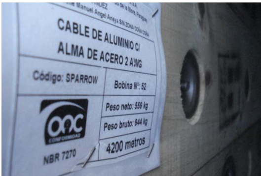
Bobina de cable de aluminio de 6 hilos con alma de acero ACSR#2 para uso del tendido electrico
