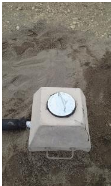
Figura 04. Armado celda mecánica, tuberías y Bloque de concreto celda CR-26.
