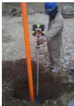
Figura 11. Control topográfico y posterior protección con material 2B del plato de medición colocado sobre medidor magnético de asentamiento MM-03.
